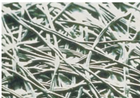
2 pav. Typar® vaizdas po mikroskopu
