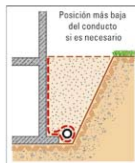
Con DuPont™ Typar® combinado con un estrato drenante de tipo placa de drenaje de plástico estriado/poliéster expandido (drenaje compuesto).
