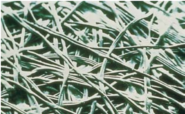
Figura 2: Vista al microscopio de DuPont™ Typar®.
