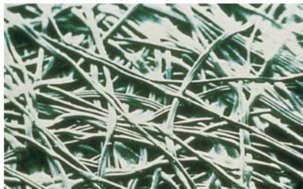
Figure 2 : Vue microscopique de DuPont™ Typar®.
