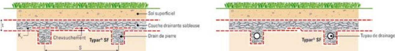
Figure 32 : Section de deux différentes couches drainantes utilisant DuPont™ Typar® SF.
